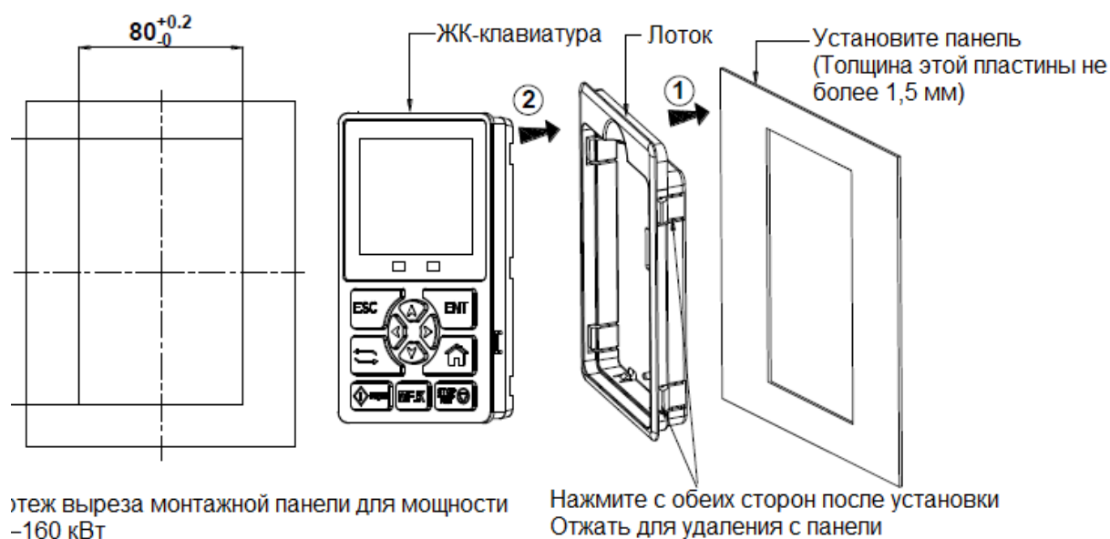
Рис. d-1. Чертеж выреза для внешнего монтажа клавиатуры ПЧ РМ30.
